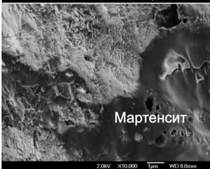
Рис. 3.2, в. Мікроструктура мартенситної складової листів сталі DP600 ( \times 20,000 ) у вихідному стані
