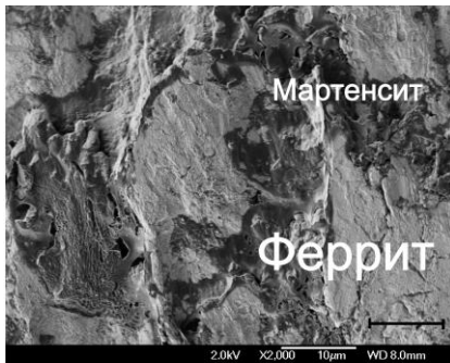
Рис. 3.2, а. Мікроструктура листів сталі DP600 ( \times 2,000 ) у вихідному стані.
