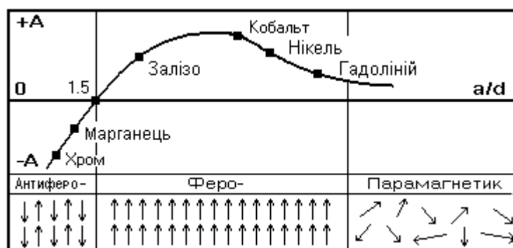
Рис. 1.1. Схематична залежність інтеграла обмінної енергії A від відношення періоду решітки a до діаметру незаповненої електронної оболонки d .
