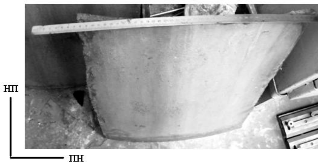
Рис. 2.3. Фрагмент зразка циліндричної форми зі сталі 09Г2С.
