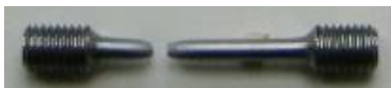
Рис. 2.4. Зразок після випробувань на одноосьовий розтяг.
