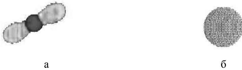
Рис. 3.42 Парціальна електронна густина останнього зайнятого стану в енергетичному спектрі ізольованого атому Ni (а) та повна електронна густина (б) для ізозначення 0.8-0.7 від максимального
