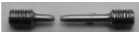
Рис. 2.5. Зразок сплаву Ст20К після випробувань
