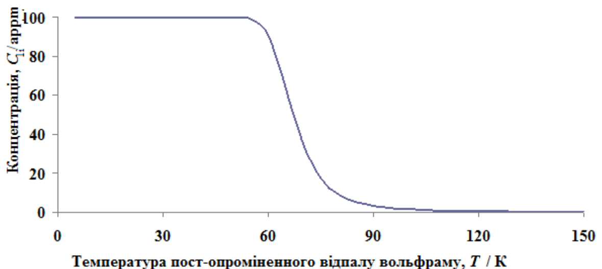
Рис. 4.8. Температурна залежність концентрації вільних міжвузельних атомів ( C_{1i} ) у пост-опроміненному відпаленому вольфрамі за результатами КД для моделі з 1D дифузією міжвузельного атому.
